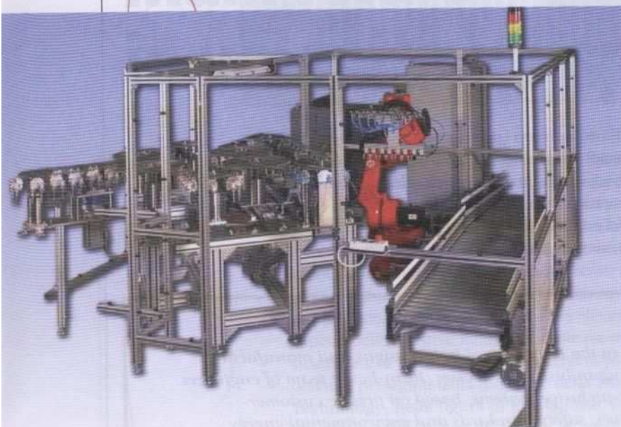
Il sistema è in grado di depositare in modo 'ordinato' i dispenser all'interno dei cartoni di spedizione.
